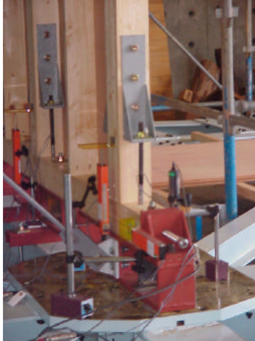
Figure 5. Détail d'un tirant d'ancrage
