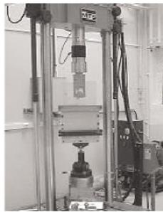
Figure 2. Montage des essais réalisés pour la détermination de la résistance ultime de plaques de verre trouées
